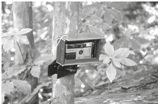
図108：自動撮影装置。夜行性の哺乳類の生息確認に強力な道具。
