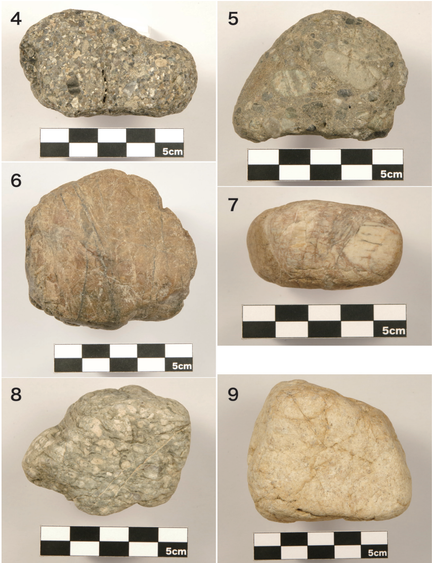
図13：(つづき)。4-れき岩：米粒くらいの小さなれきをぎゅっと押し固めたようなれき岩。れきとれきの中の基質が少ない。5-れき岩：1～3cmくらいのれきと、まわりを埋める基質がよく分かる。6-チャート：赤色チャート。チャートはまん丸の石ころが多いが、これは少し欠けてゴツゴツしている。7-チャート：白っぽいチャート。8-流紋岩：流理構造が観察できる。白い鉱物はカリ長石。9-流紋岩：ポツポツとした透明の点々に見えるのは石英。
