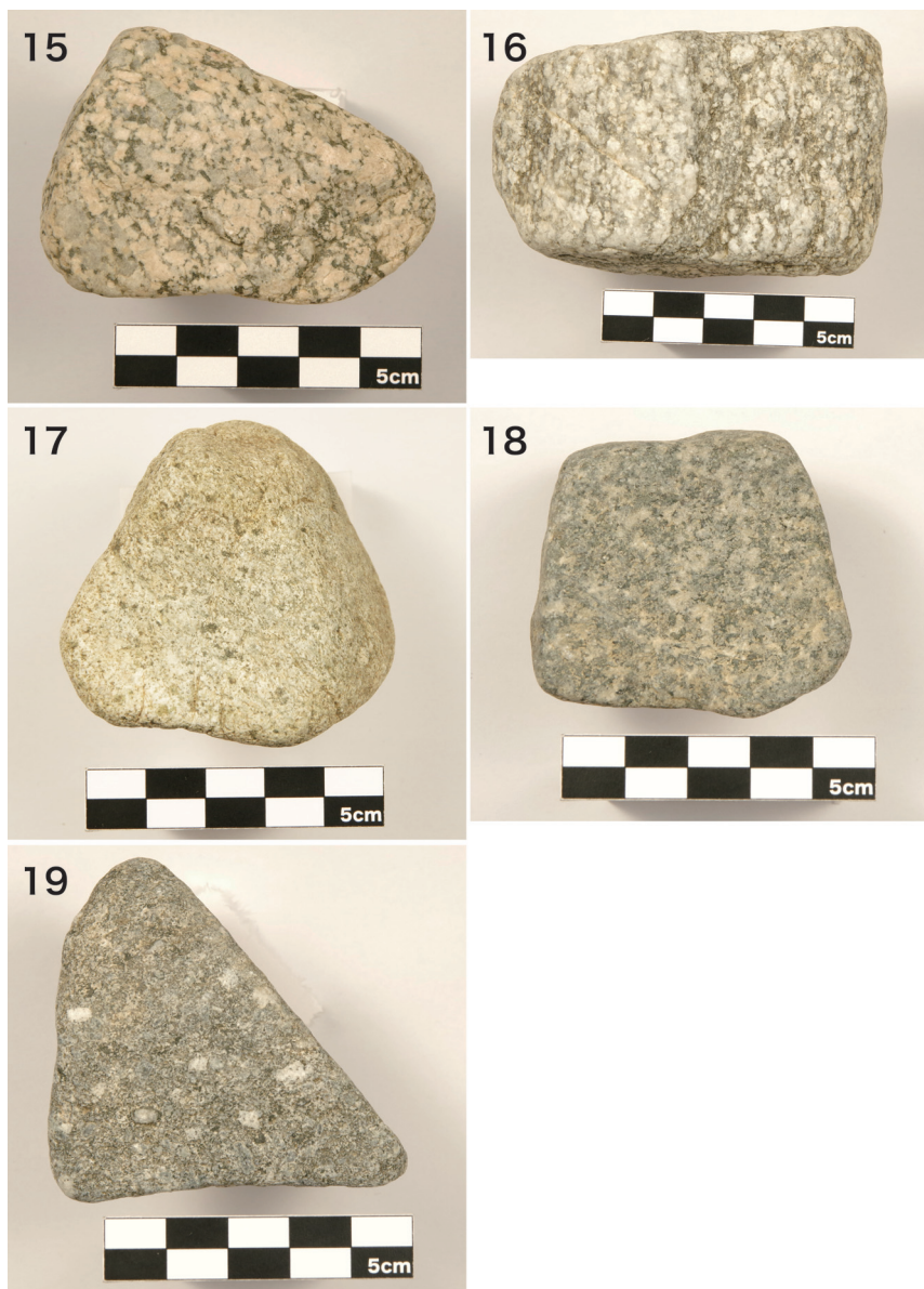
図5：(つづき)。15-花こう岩：淡いピンク色のカリ長石が目立つ。16-花こう岩：優白質な花こう岩。17-花こう岩：細粒な花こう岩。18-閃緑岩：カリ長石も含まれているので、正確には花こう閃緑岩。19-閃緑岩：細粒な閃緑岩。白い斜長石の斑晶が目立つ。
