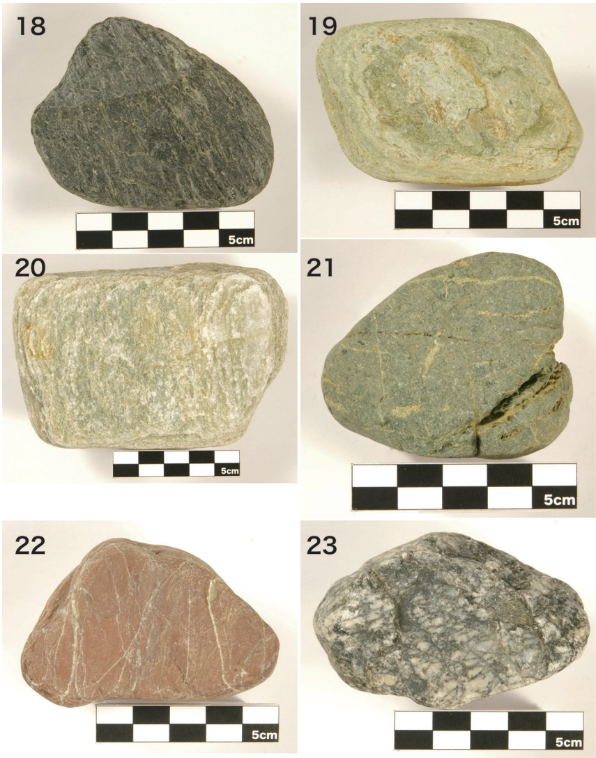
図15：(つづき)。18-黒色片岩：泥岩が變成作用を受けてできる。薄くはがれたような形と、表面のちりちりしたしわ模様が結晶片岩類の特徴。19-緑色片岩：緑色岩が變成作用を受けてできる。20-石英片岩：チャートが變成作用を受けてできる。表面のキラキラした鉱物は絹雲母。21-緑色岩：付加体に含まれる岩石で、海洋底で噴出した玄武岩が變質してできた。22-チャート：赤色のチャート。23-チャート：灰色のチャート。
