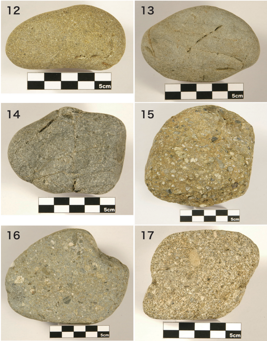
図15：(つづき)。12-砂岩：中粒の砂岩。13-砂岩：細粒の砂岩。14-砂岩：中粒で、基質多くて砂粒がわかりにくい。15-れき岩：チャートのれきが多く含まれている。16-凝灰岩：鉞物片や流紋岩の角れきが含まれる。17-凝灰岩：砂岩によく似た見かけだが、鉞物片の集合や新鮮な石英、火山岩の小さな角れきなどが含まれていて、砂岩とは異なる。
