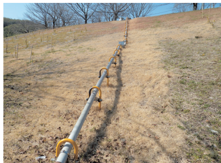
図4-4：地すべりを監視する伸縮計。
