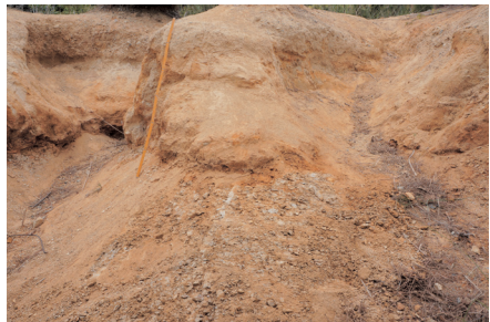
図5-2：和泉市鶴山台惣ヶ池の露頭。折れ尺より下の緩い崖が海成粘土層。
